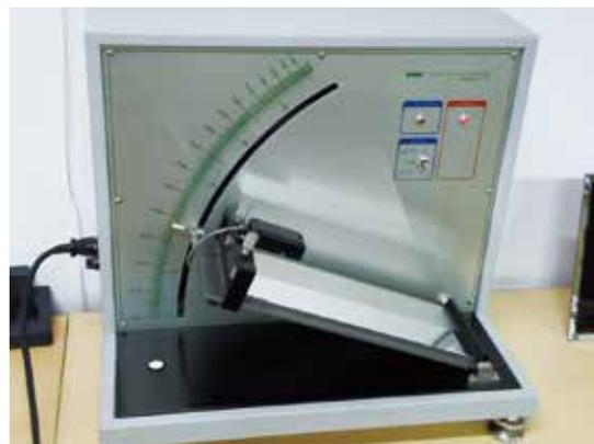
レール：SUS304、摺動物：PET樹脂で評価。レーザ加工品は鏡面レールに対して低摩擦化、傾斜角度を $14^\circ$ から $8^\circ$ に改善した。
